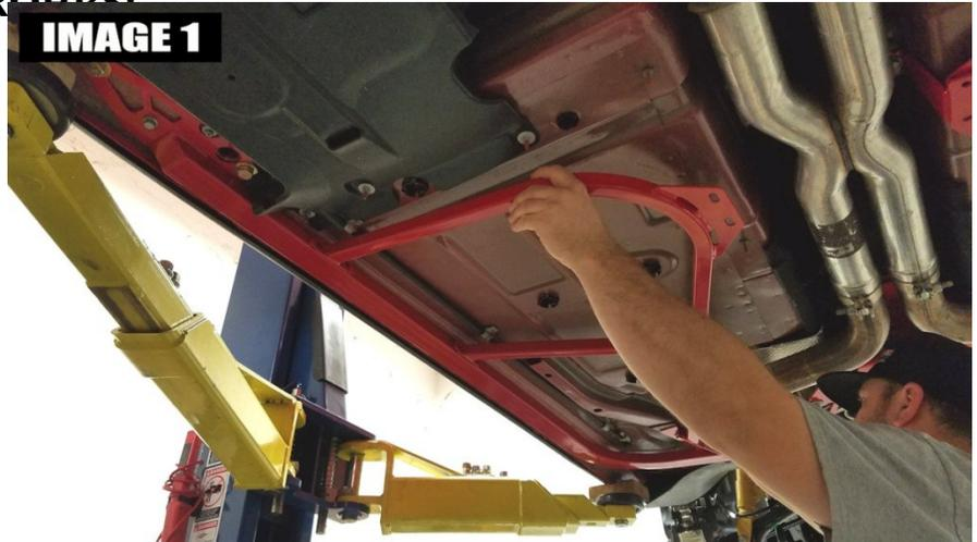
2. Verbinden Sie das Dreiecksrohr mit den mitgelieferten 3/8" x 1" Schrauben und Unterlegscheiben mit dem äußeren Hilfsrahmenanschluss. Es gibt 5 Schrauben pro Seite. Verwenden Sie eine Mutter und eine Unterlegscheibe an den vorderen Anschlüssen. **BILD 2**.
