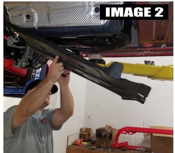
Platz. Wenn Ihr Fahrzeug keine Gewindelöcher hat, müssen Sie die Wagenheberschiene mit einem Wagenheber festhalten, bis ein neues Loch gebohrt wird.
