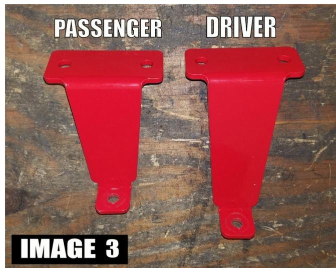
4. Entfernen Sie die Schrauben des Trägerlagers mit einer 13-mm-Stecknuss. Verwenden Sie **BILD 3** zur Identifizierung der Teile und schrauben Sie die entsprechenden BMR-Halterungen an die Trägerlagerhalterung. **HINWEIS:** Die BMR-Halterungen sitzen unterhalb der Hilfsrahmen-Verbindungshalterung, wie in **BILD 5** auf der nächsten Seite dargestellt.
